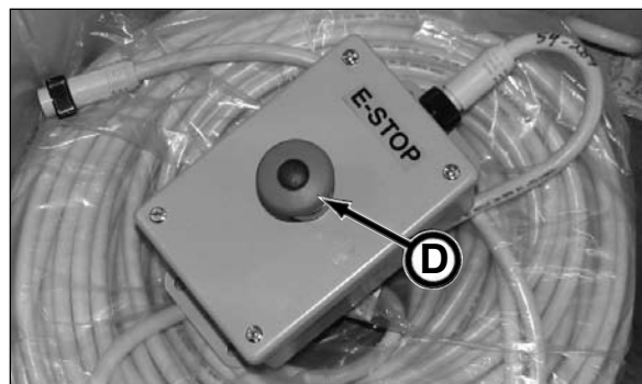
Remote E-Stop (D) on EPB Power Container
