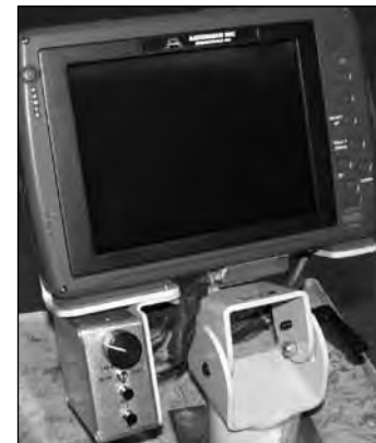
Sistema de orientação (SN FA42035F-87 e posteriores) com controle de foco remoto - Equipamento padrão
